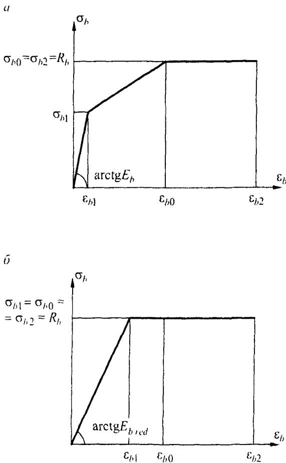
*a* – Трехлинейная диаграмма состояния сжатого бетона;
