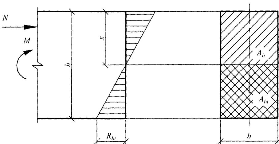
*Рисунок 7.2 – Схема усилий и эпюра напряжений в сечении, нормальному к продольной оси изгибающего (внецентрично сжатого) бетонного элемента, рассчитываемого по прочности с учетом сопротивления бетона растянутой зоны*
