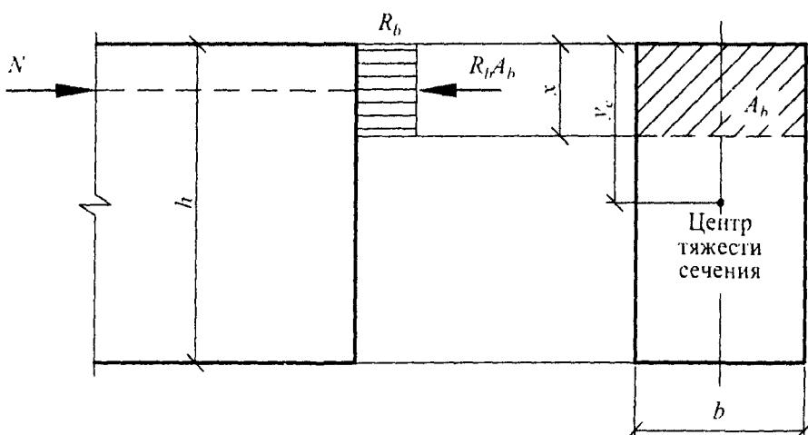
*Рисунок 7.1 – Схема усилий и эпюра напряжений в сечении, нормальному к продольной оси внецентрично сжатого бетонного элемента, рассчитываемого по прочности без учета сопротивления бетона растянутой зоны*
