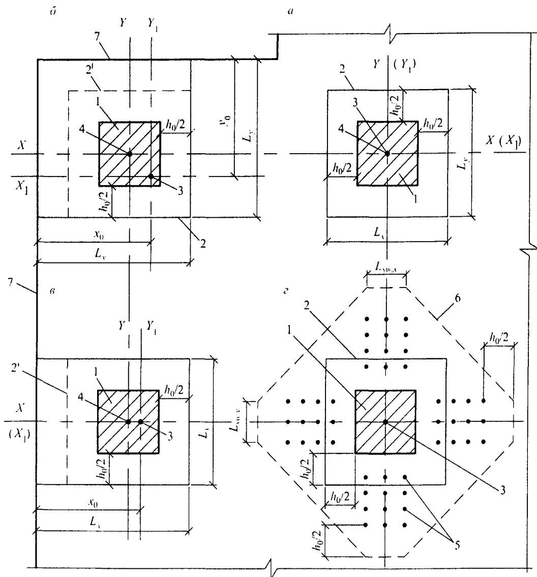
*a* – площадка приложения нагрузки внутри плоского элемента; *b*, *c* – то же, у края плоского элемента.
