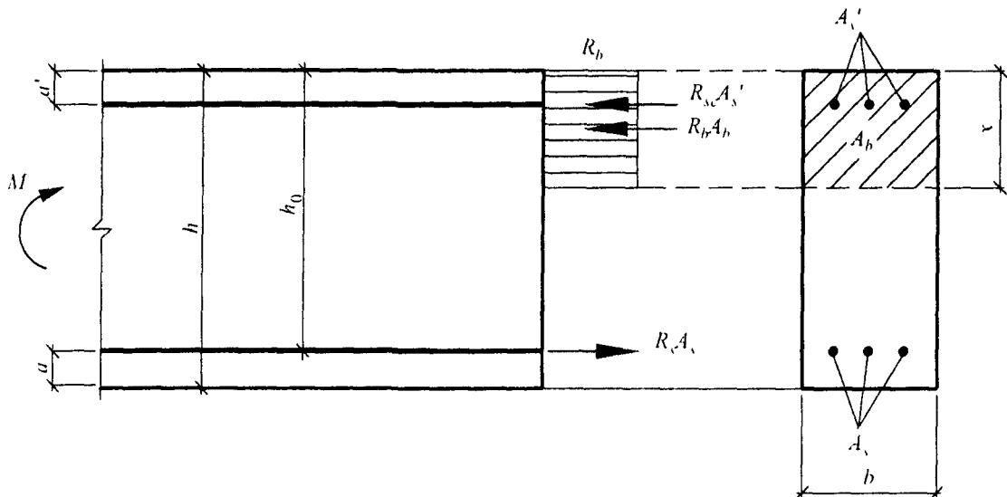
Рисунок 8.1 – Схема усилий и эпюра напряжений в сечении, нормальном к продольной оси изгибающего железобетонного элемента, при его расчете по прочности
