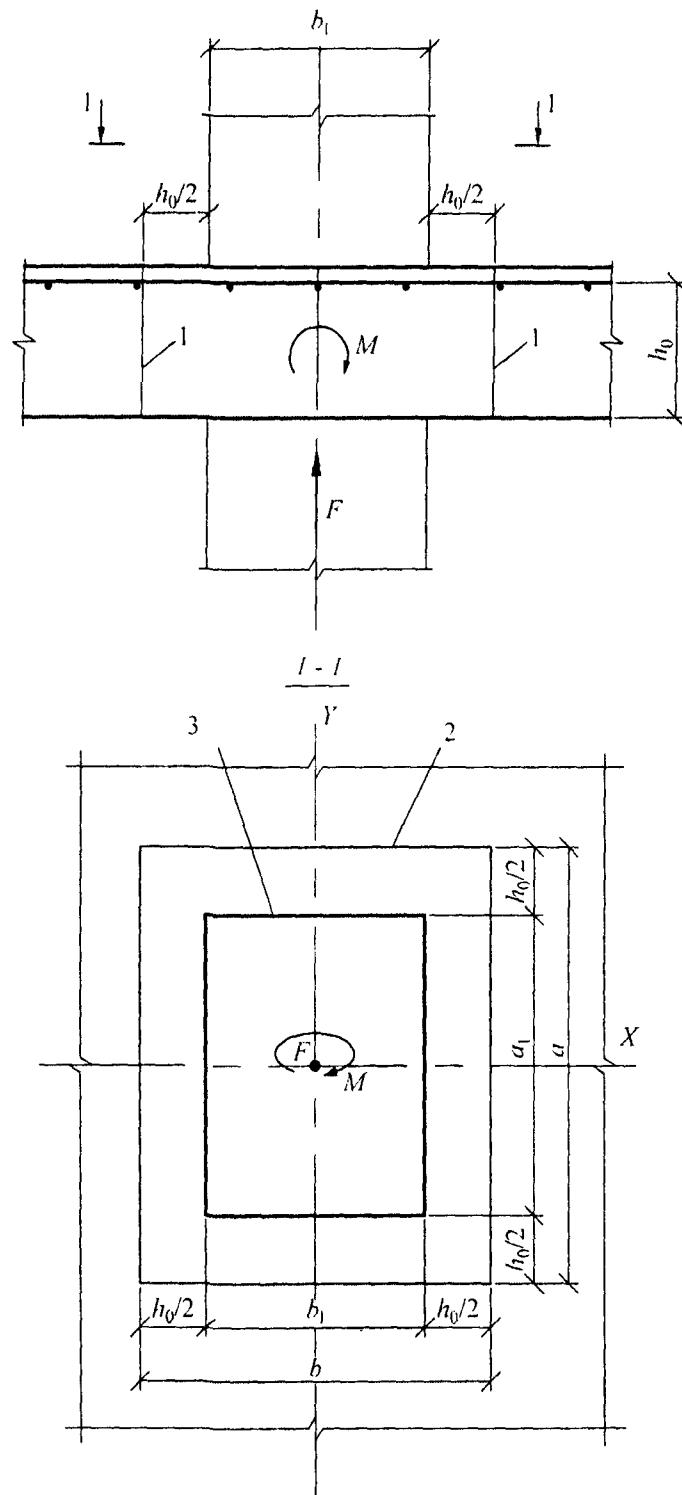
1 – расчетное поперечное сечение; 2 – контур расчетного поперечного сечения; 3 – контур площадки приложения нагрузки
